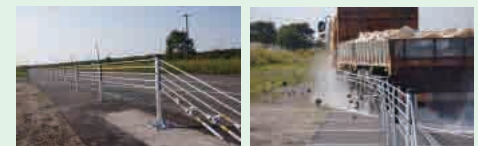
ワイヤーロープ式防護柵と衝突実験（大型貨物車）の様子
