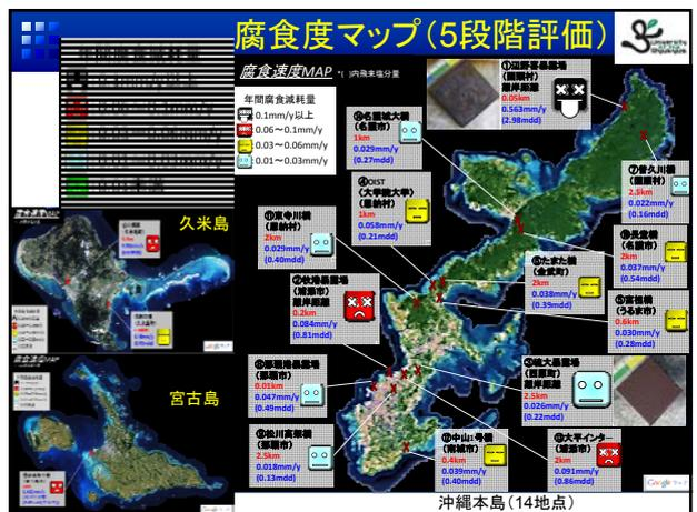
**腐食鋼橋の事例：腐食度** ☹️☹️  $0.06 \sim 0.1 \text{mm/y}$
