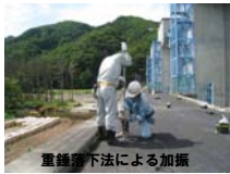
重錘落下法による加振
