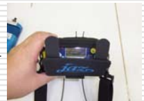
光源・検出器・モニタ・バッテリーが一体となった可搬型計測器
