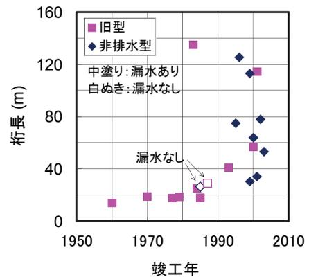
既設コンクリート道路橋21橋の桁端部調査の結果による
