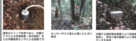
●傾斜角測定タイプ…崩壊検知だけでなく、傾斜角を常時測定する形式→崩壊の前兆をとらえることが可能
