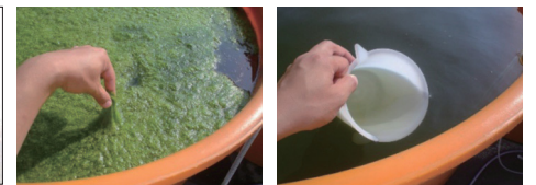
模擬修繕池の糸状藻類発生状況 左：通常の下水処理水 右：担体で処理した下水処理水
