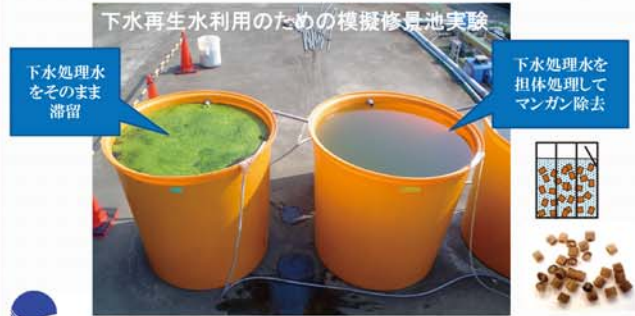
模擬修景池で観測された藻類の繁茂状況(滞留時間7日)
