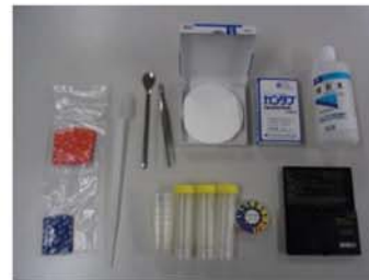
簡易塩化物イオン濃度測定器具
