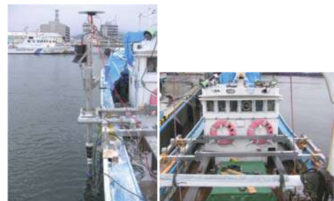
架装装置、艦装用架台を取り付けた状態
