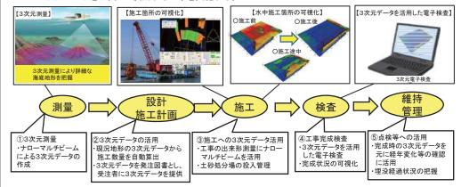
平成28年度末までに3次元データの活用を前提とした基準類を整備するとともに、 積算基準にマルチビー ムによる深浅測量等の施工歩掛を追加
