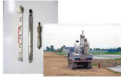
コーン貫入試験の様子
