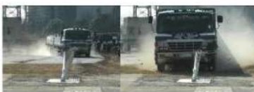
大型車の防護柵衝突後の軌跡(2012年1月)
