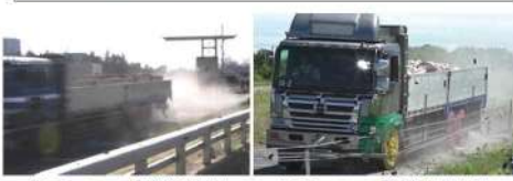
H23 ロープ連結材なし H28 ロープ連結材あり 前輪タイヤのロープ押し下げ(3本から1本に)防止に有効 最大進入行程: 1.48mから0.985mに低下 (※張力12kNの衝突実験においても0.95mを記録)
