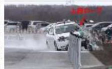
H28 ロープ連結材あり 最大進入行程: 1.05mから0.94mに低下し、上段ロープの押し上げ防止に効果を発揮
