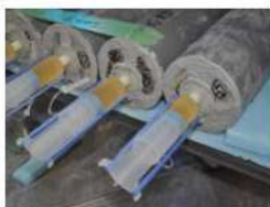
割製ひび割れを入れたφ10×20cm円柱供試体に樹脂系注入材を注入
