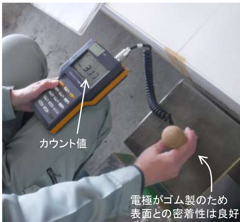
電気抵抗式水分計によるチェック状況
