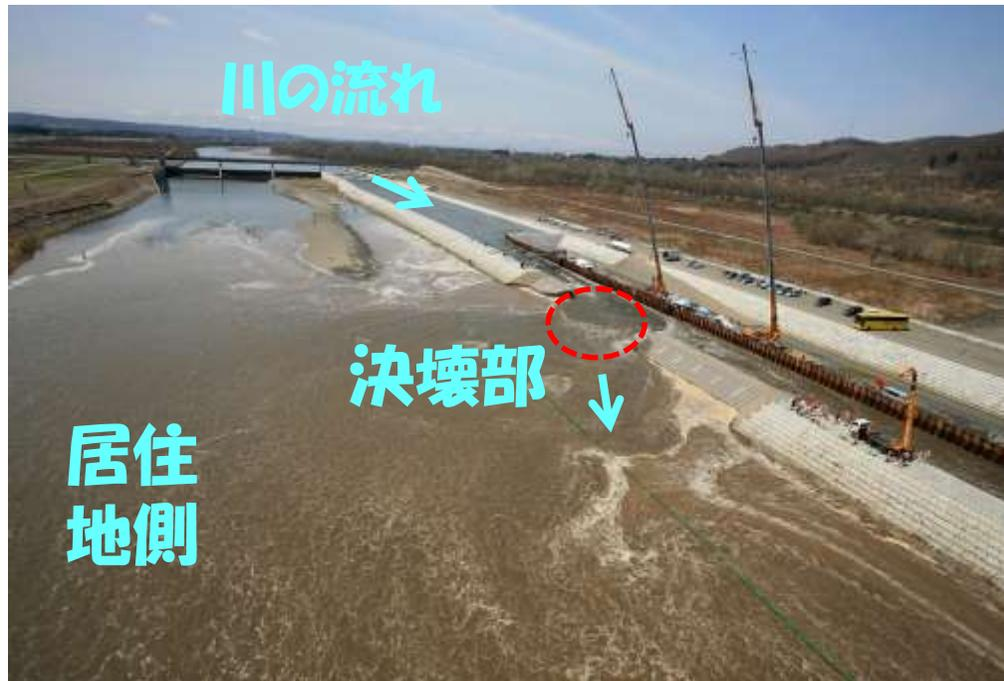
実物大規模の堤防決壊実験
