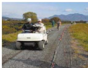
道路盛土や河川堤防などの土構造物の新規建設や既設構造物の防災・維持管理のためには、浅部の地盤構造や物性分布を把握することが必要である。そこでそれらをイメージングし、弱点箇所を効的に抽出できる物理探査手法を研究・開発した。電気探査と表面波探査等を組み合わせて適用する統合物理探査技術である。本技術の手法をまとめた「河川堤防の統合物理探査—安全性評価への適用の手引き—」（平成25年3月出版予定）についても紹介する。
