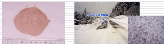
化学系凍結抑制舗装の一例（火成岩粉末に塩化物を吸着）
