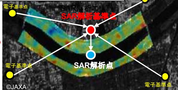
干渉SAR時系列解析+電子基準点
