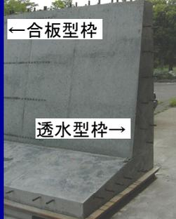
・透水型枠での接触時間<合板での接触時間
