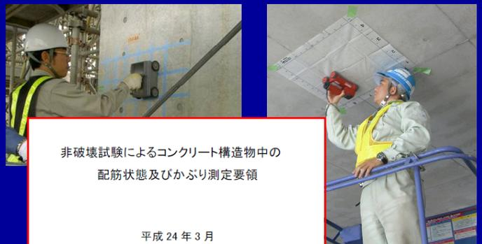
非破壊試験によるコンクリート構造物中の配筋状態及びかぶり測定要領
