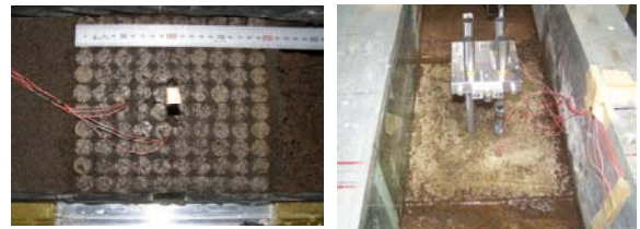
レベル2加振後の状況 = 健全
