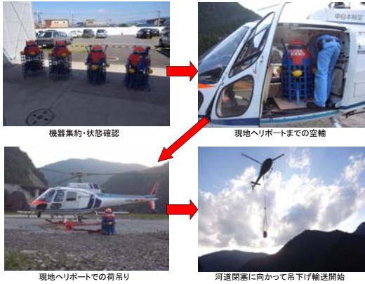
機器集約・状態確認 現地ヘリポートまでの空輸 現地ヘリポートでの荷吊り 河道閉塞に向かって吊下げ輸送開始
