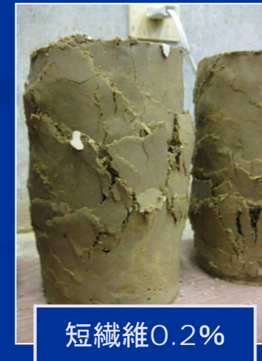
試験後の供試体 (セメント添加量5%)
