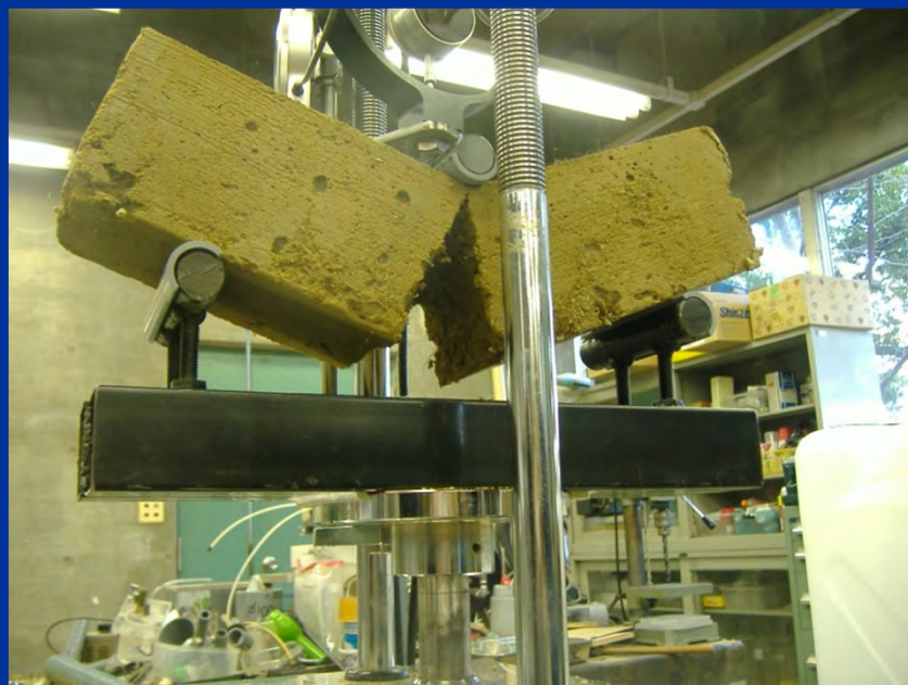
曲げ強度試験状況
