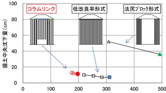
・盛土の沈下抑制に優れる低改良率形式と同程度の効果を確認
