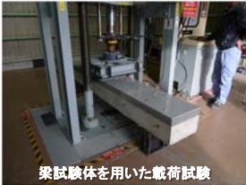
梁試験体を用いた載荷試験
