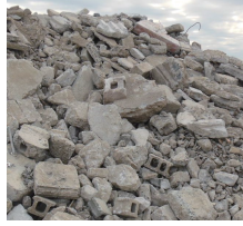
鉄筋・ブロック・レンガ等が混入 → 分別せずに使用
