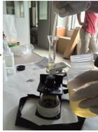
潤滑油をポンプ(AC100V電源)により吸引濾過することにより、メンブランフィルター上に不純物が捕集される。
