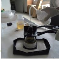
エーテルで洗浄することで油分を流され、不純物だけがフィルター上に残る。
