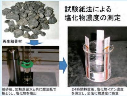
破砕後、加熱蒸留水と共に攪拌瓶で振とうし、塩化物を抽出
