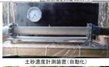
土砂濃度計測装置(自動化)
