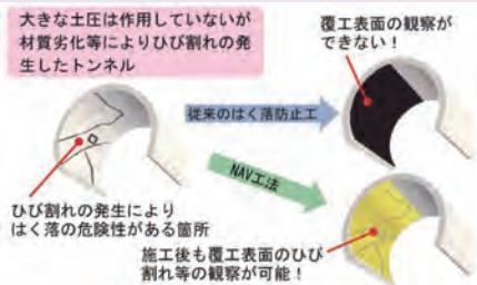
ひび割れした覆工コンクリートの表面に、新しく開発した透明のシートを樹脂等で接着し、剥落を防止する技術。施工後においてもひび割れの進展が確認できるため、効果の確認や追加対策工の必要性の判断が可能。
