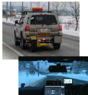
連続路面すべり抵抗値測定装置(CFT) CFTの測定原理
