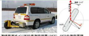
連続路面すべり抵抗値測定装置(CFT) CFTの測定原理
