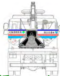
多機能型災害対策車 + 排水ポンプ設置支援ユニット
