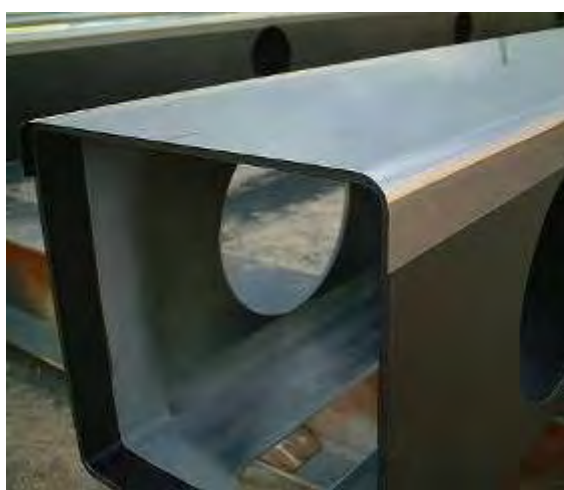
チタン箔シート貼付後状況
