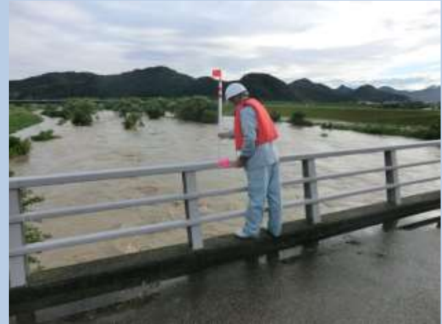
洪水時の流量観測(高水流観)
