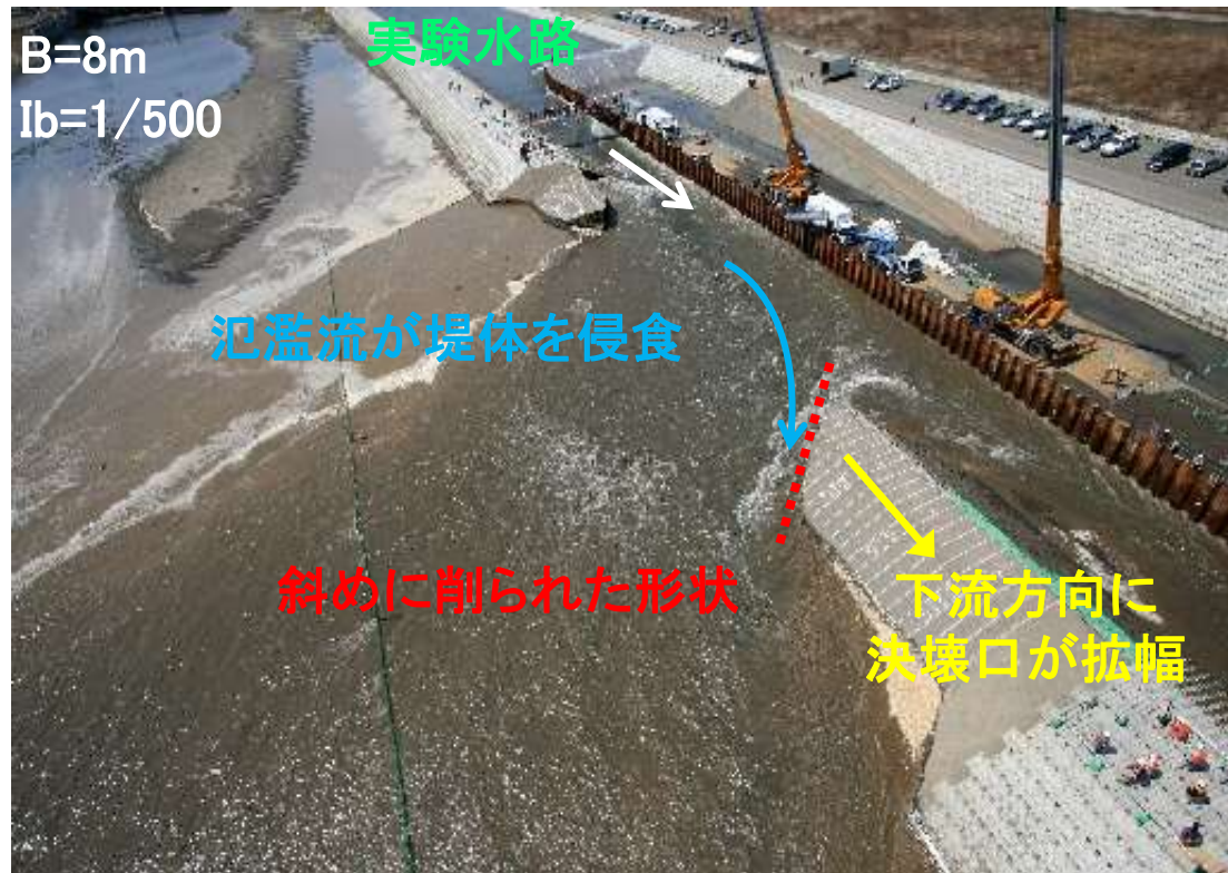
千代田実験水路での堤防決壊実験
