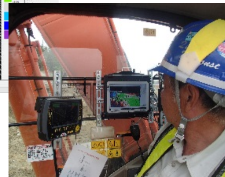
重機内に搭載したコンパクトモニタ
