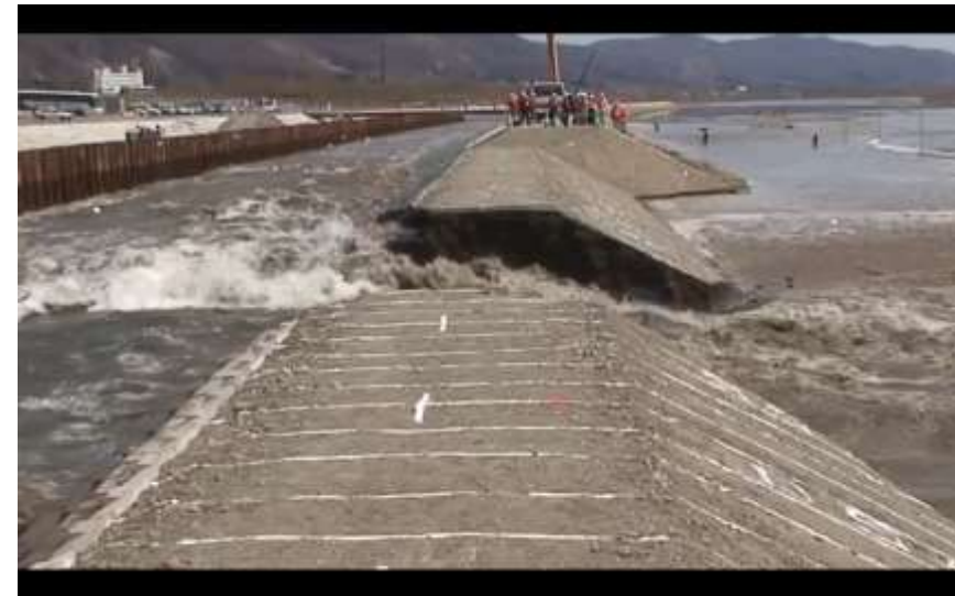
千代田実験水路における決壊口の拡幅状況
