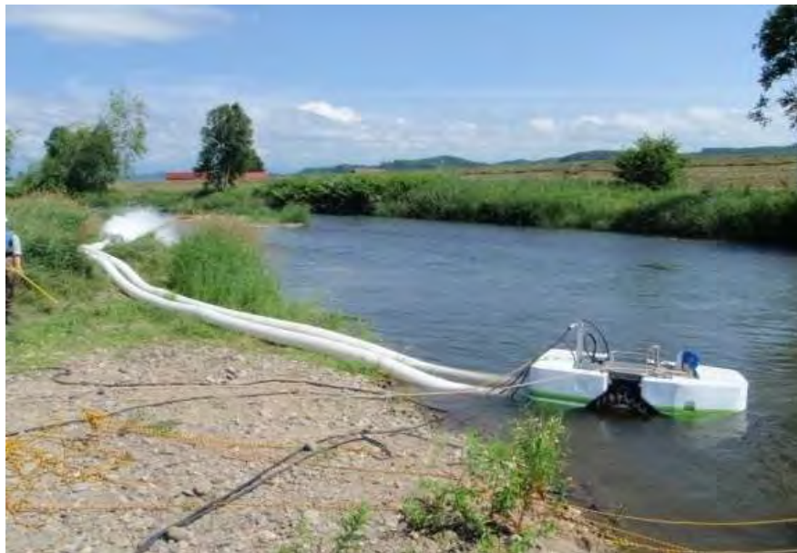
水深約1m以上で本体は完全に浮いた状態
