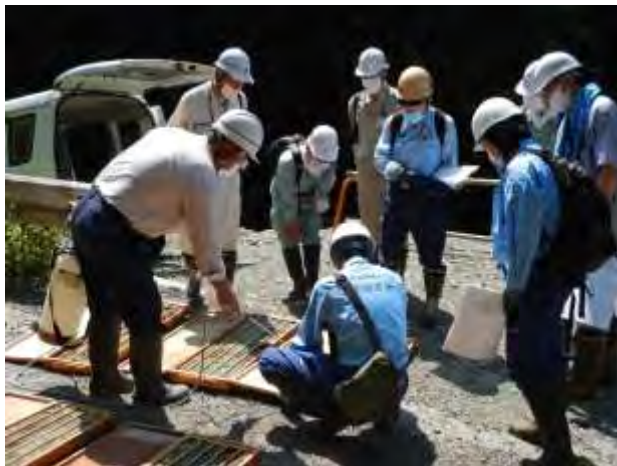
ボーリングコアの確認
