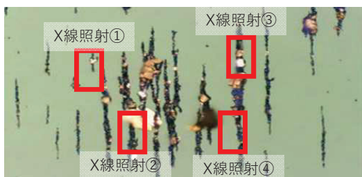
潤滑油フェログラフィー (精密評価を行ったベアリング)
