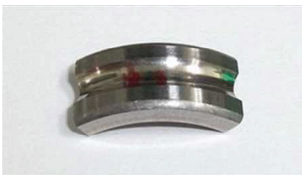
ベアリング内輪部 (切断)
