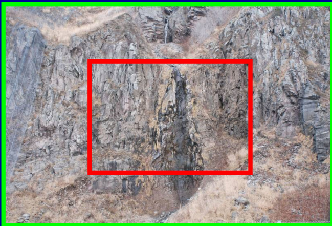
焦点距離35mm(緑枠)と焦点距離70mm(赤枠) 設定の異なる画像比較における歪みの抽出
