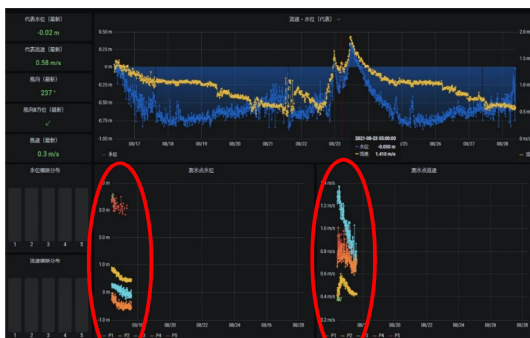
定点の流速と水位を常時計測
