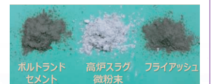
※高炉スラグは製鉄所で発生する副産物 ※フライアッシュは石炭火力発電所で発生する副産物
