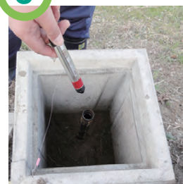
水位計の挿入
