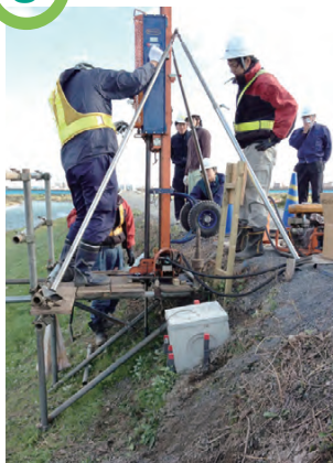
打ち込み用ロッドを打撃貫入し、先端コーンと有孔部のみを露出
