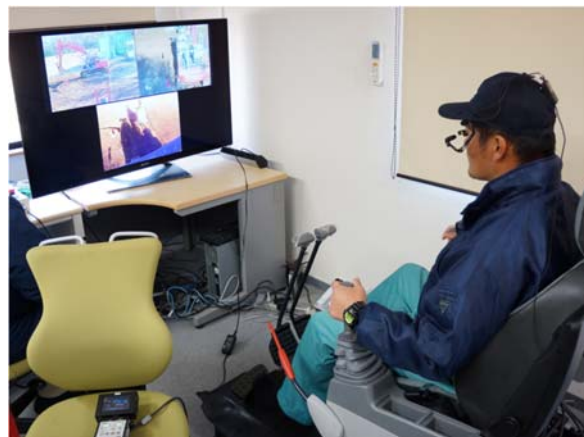
Fig. B-13 操縦型遠隔装置による操作状況
