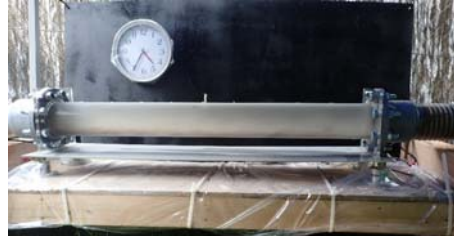
土砂濃度計測装置(自動化)
