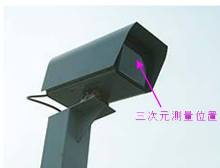
写真 5 CCTV カメラレンズの三次元測量位置
