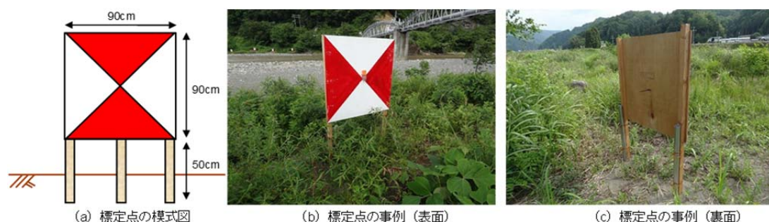
図 11 ベニヤ板で作成した標定点の例
