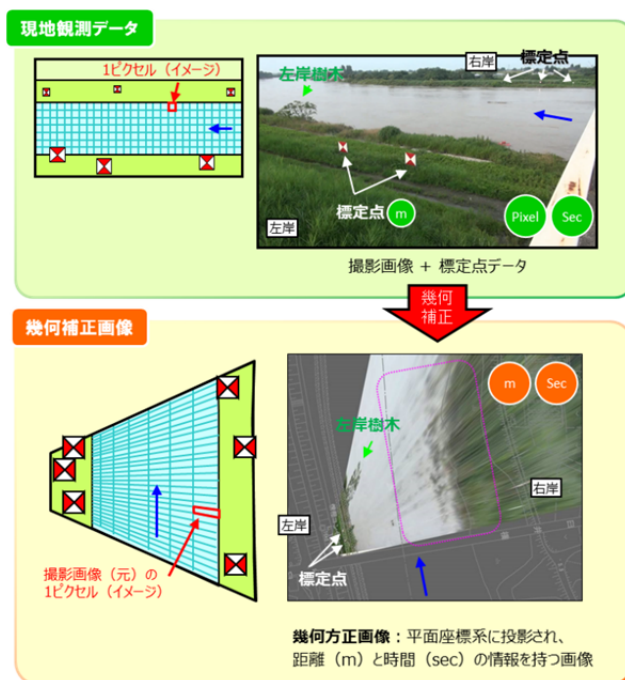
図 5-3 幾何補正の概念図
