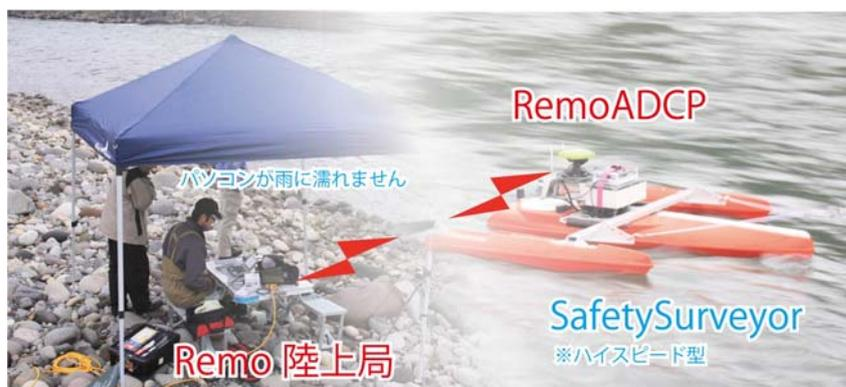
図 2-10 データ転送装置 (RemoADCP) による観測風景
