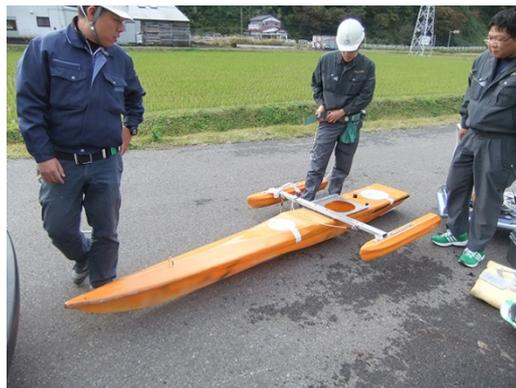
山地急流河川等、トリマラン B 型で想定しているよりも高流速、高波高での観測に対応するために開発。トリマラン B 型でも揺動が無視できなかつた環境下において、安定して観測できることを確認している。
