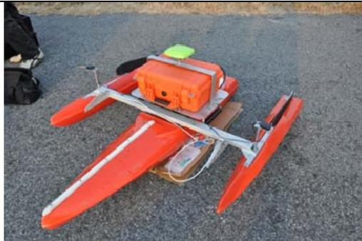
高速低揺動型。設計耐用流速は 6.0m/s とあるが、実際 5.5m/s の状況下で安定的にデータ取得できることが確認されている。機材を全て装備した際の重量は 25kg 程度と重いため、水面への上げ下ろしはウインチの付いた台車を準備した方がよい。
