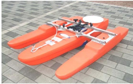
最も普及している標準型。小型軽量で専用のバッグにコンパクトに収納でき、持ち運びも便利である。流速 3m/s 程度を越えると安定性が悪くなり、データ欠損が多くなってくる。
