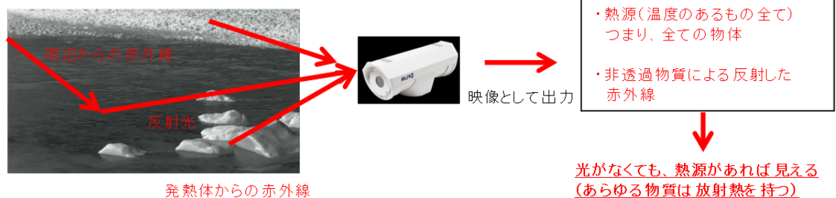
図 6 カメラの原理
