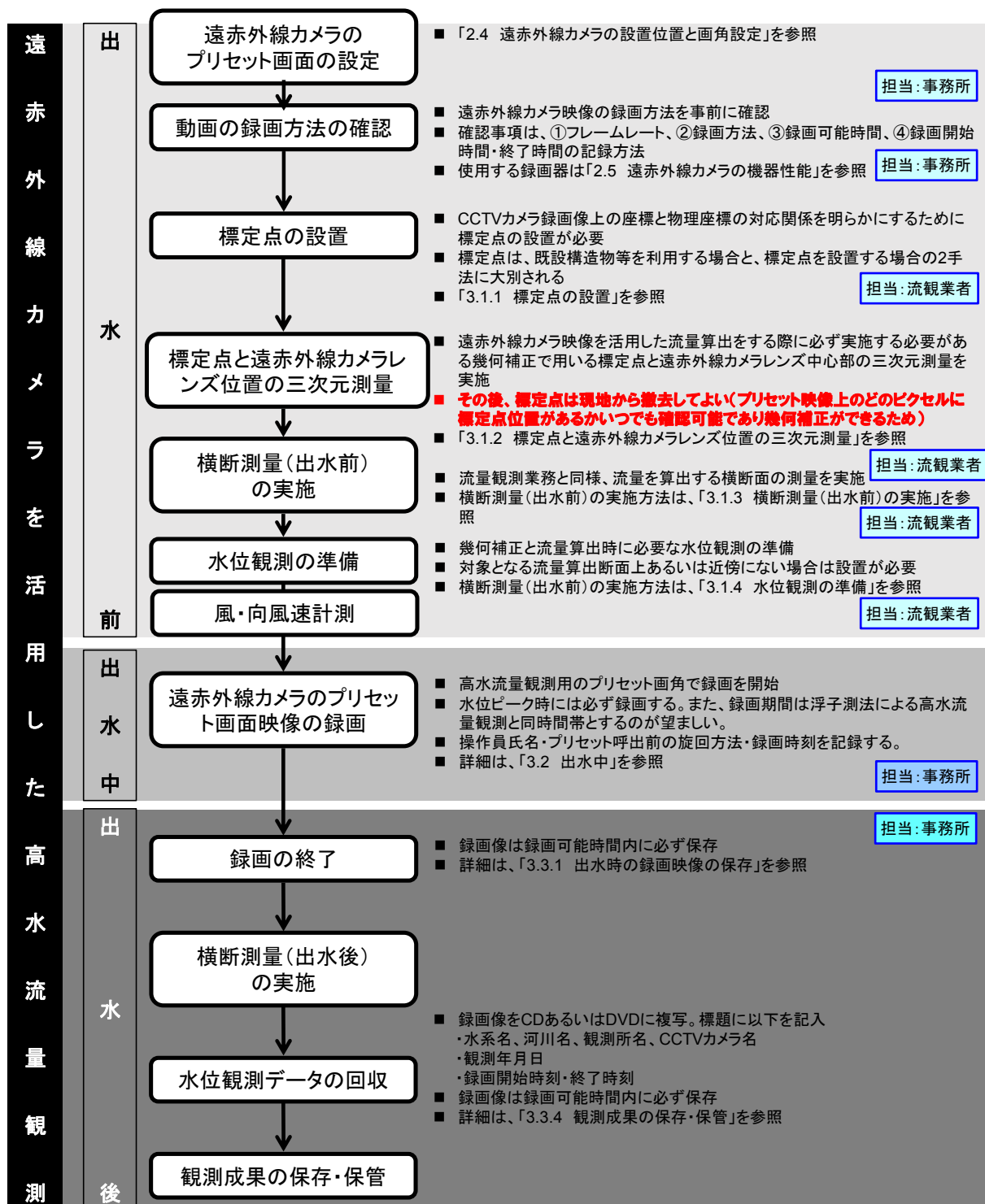
図 12 遠赤外線カメラを固定化した場合の実施フロー図
