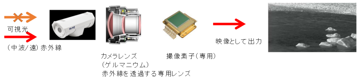
図 5 カメラが映像を映す原理
