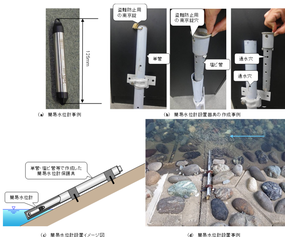
写真 3 簡易水位計とその設置事例
