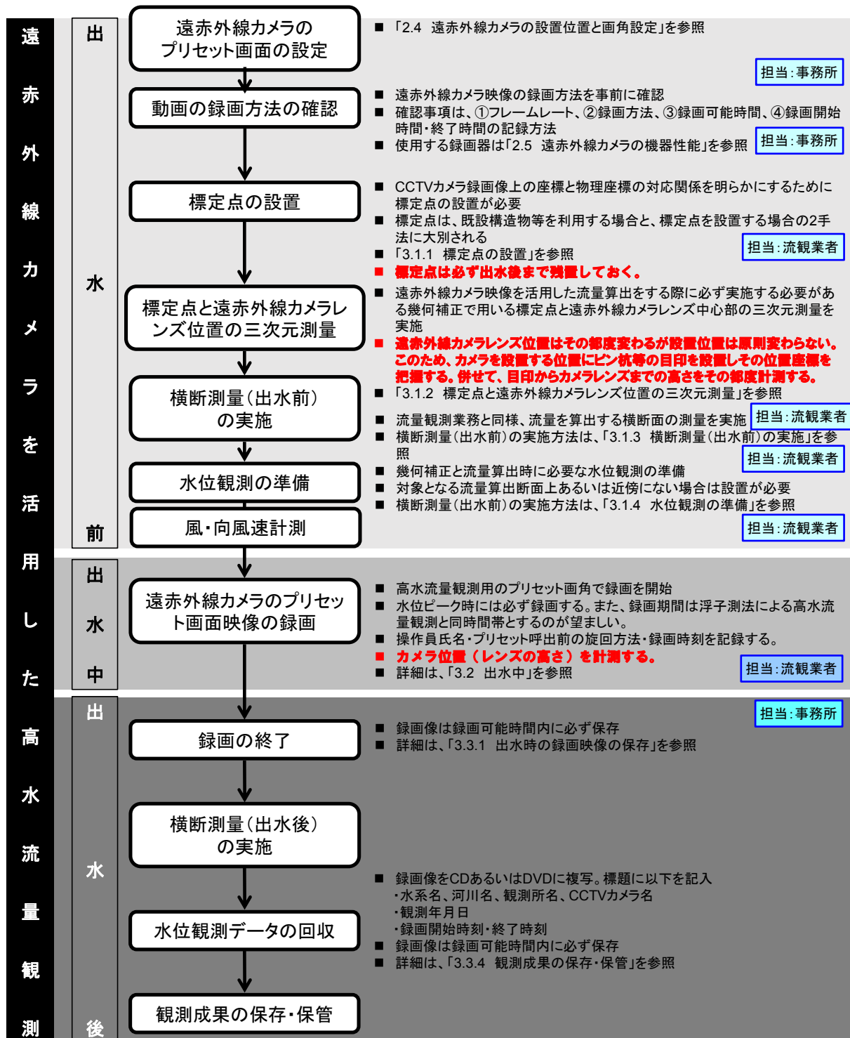
図 13 遠赤外線カメラを固定化しない場合の実施フロー図
